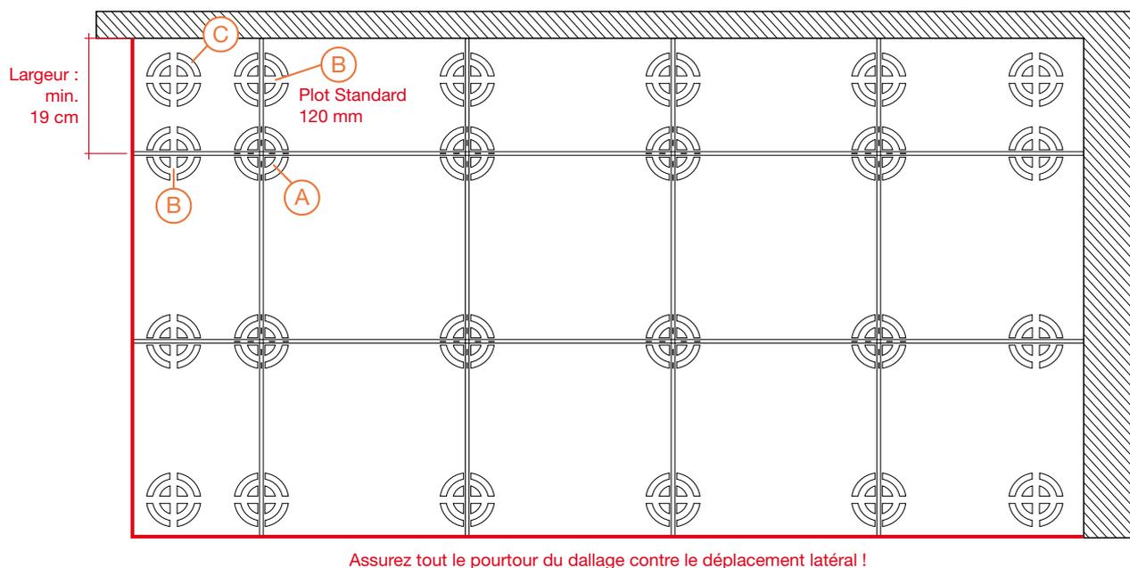
Nous conseillons de commencer par observer quel sera le niveau supérieur maximum du dallage avec outils et appareils appropriés pour voir quelles dénivellations devront être compensées avec des rondelles de compensation additionnelles.
