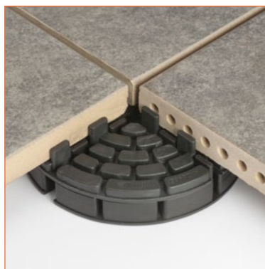
Maxi-Lager 20/4x10 und Maxi-Lager 10/4x10 gestapelt, verlegt unter einer Keramikplatte
